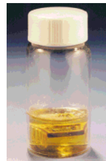
Abbildung 3. Von einem 80:20-Copolymergemisch aus 2 und 1 eingekapselter Test-Mikrochip.
